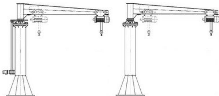
Кран монтируется на колонну-опору, либо возможно крепление опоры в несущей стене здания, поворот балки осуществляется вручную, механически, с помощью электропривода, угол поворота — до 360°. Колонна крана крепится к полу на подготовленный фундамент с помощью анкерных болтов. Консоль крана представляет собой кронштейн со стрелой, изготовленной из тавровой балки с упором для ограничения движения тали.
